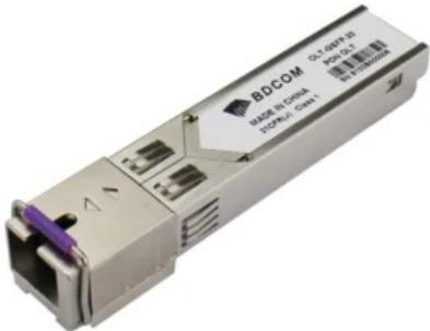
Модуль BDCOM SFP WDM GEAPON, дальность до 20км (32dB), Tx/Rx: 1490/1310нм
