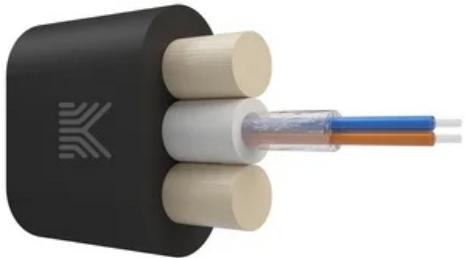
**Дроп-кабель плоский, с центральной трубкой, усилен стеклопрутками, 2 волокна, SM 9/125, G.657.A1, полиэтилен, 1.5 кН**
