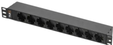
**Блок электрических розеток TLK, 19", 9 гнезд "евророзетка", макс. нагрузка 10 А, без шнура питания, вход C14 + предохранитель 10 А, метал. корпус**
