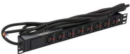
Блок розеток серии SNR-PDU с локальным измерением на 8xC13 с фиксаторами, шнур питания 3м 3x2.5мм<sup>2</sup> без вилки, 230В, 16А
