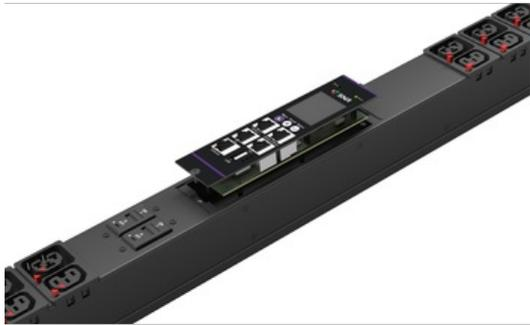
Блок розеток с функцией измерения каждой розетки серии SNR тип В выход 21\*C13/19L и 21\*C13L с фиксаторами вход 16A IEC60309 (3P+N+E)
