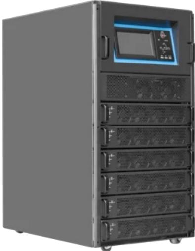
Шасси модульного источника бесперебойного питания 60 кВА/60 кВт серии СМ, 6 слотов для силовых модулей 10 кВА/10 кВт (SNR-UPS-ONRT-060-10CMX33)
