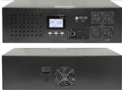
Источник бесперебойного питания Line-Interactive SNR LIRM 2000ВА/1600Вт (PF-0.8), 1ф:1ф (220-240В), 36В (DC) (3x9Ач) (чистый синус на выходе)
