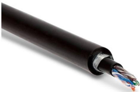
Кабель витая пара U/UTP, кат. 5e, 4 пары(24 AWG), одножильный (solid), бронир. стальной лентой, внешний, PE.
