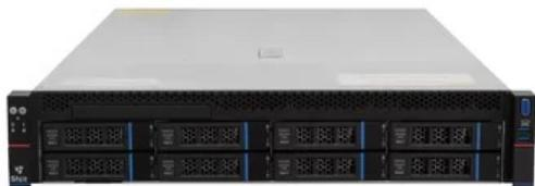
Серверная платформа SNR-SR2408RE, 2U, AMD EPYC Gen4, DDR5, 8xSATA/SAS, резервируемый БП
