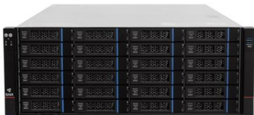
Серверная платформа SNR-SR4436RE, 4U, AMD EPYC Gen4, DDR5, 36xSATA/SAS, резервируемый БП
